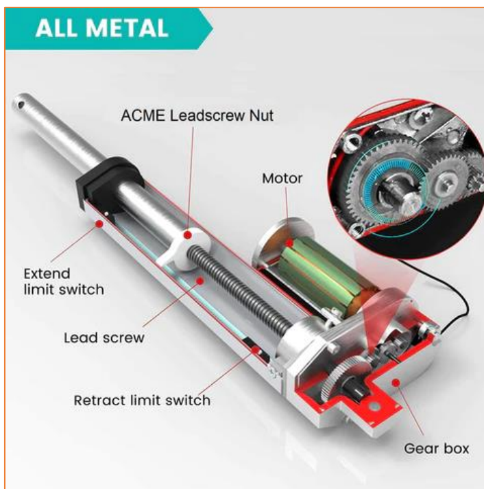
Bijlage - Dwarsdoorsnede lineaire actuator
